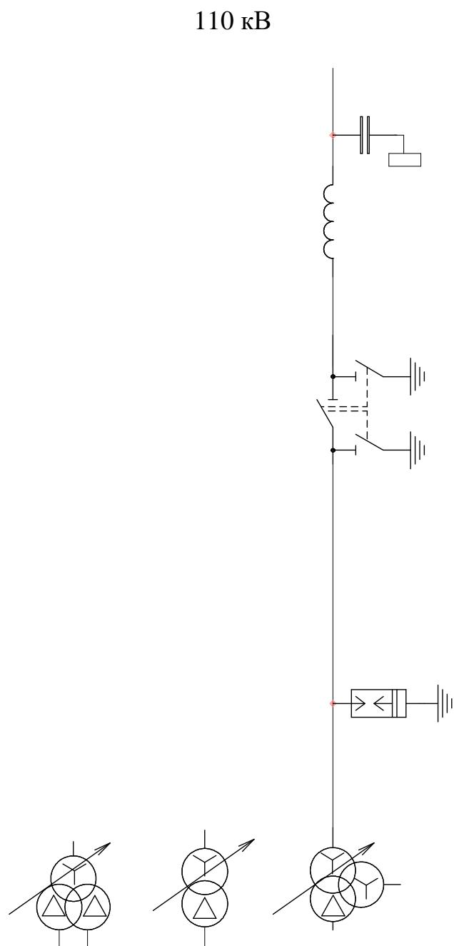
Схема №110-1. Блок (линия-трансформатор) с разъединителем
