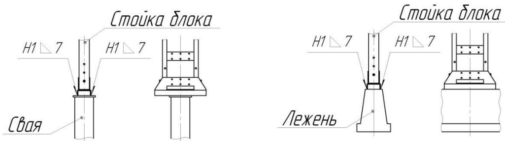
Варианты установки блоков ОРУ 35, 110 кВ на свайный фундамент и фундамент, выполненный лежнями
