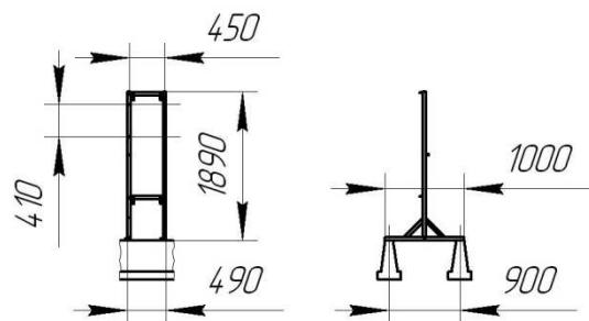
Стойка для установки шкафов дистанционного управления разъединителями 35, 110кВ
