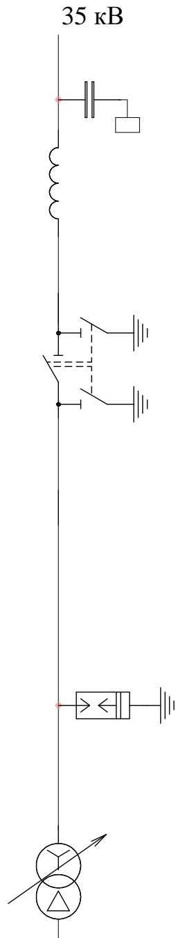
Схема №35-1. Блок (линия - трансформатор) с разъединителем
