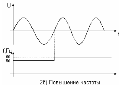
Рис. 3. Осциллограмма проверки реле частоты.
