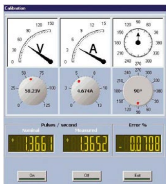
Окно ручного управления программой проверки счетчиков электроэнергии
