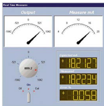
Ручное управление программой проверки преобразователей
